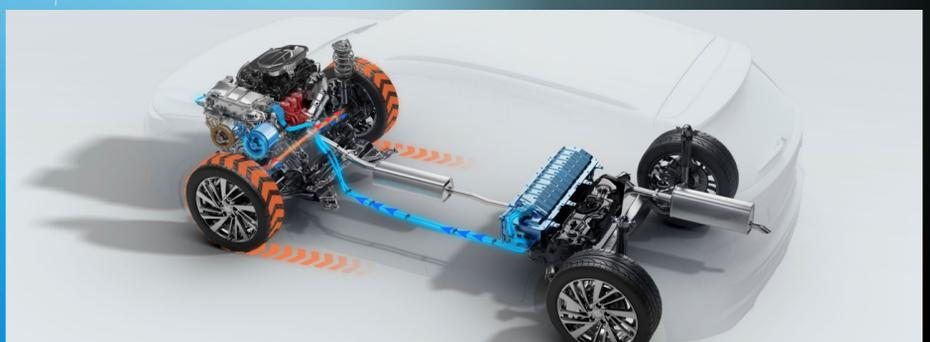
**Híbrido en serie:** en este modo, el motor eléctrico propulsa el vehículo mientras el motor de combustión interna recarga la batería a través del generador.
