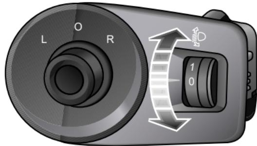
La posición 0 es la posición inicial del interruptor de nivelación de los faros. La nivelación de los faros se puede ajustar de acuerdo con la siguiente tabla según la carga del vehículo.
