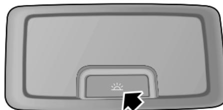
Presione el interruptor (flecha) para iluminar las luces de cortesía traseras, presione nuevamente para apagar.
