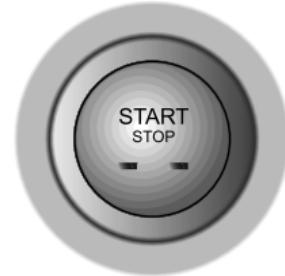
El interruptor de arranque sin llave se encuentra en el panel de instrumentos a la derecha de la columna de la dirección y pertenece al sistema del botón de arranque. Para operar el sistema, la llave debe estar en el automóvil.
