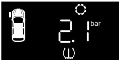
En esta interfaz, presione el botón OK en el interruptor a la derecha del volante o mantenga presionado el botón del computador de viaje en el indicador/interruptor de luces principales para mostrar la presión de los neumáticos de cada rueda en forma individual. Use los botones izquierda/-derecha en el interruptor del volante o presione brevemente el botón del computador de viaje para revisar las ruedas.
