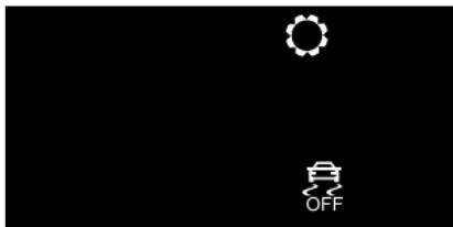
En esta interfaz, presione brevemente el botón OK a la derecha del volante o presione el botón del computador de viaje en el indicador/interruptor de luces principales para encender/apagar el sistema de control de estabilidad y el sistema de control de tracción. Cuando el sistema esté en Off, la luz de advertencia de Off se encenderá.
