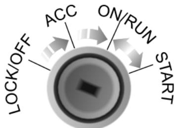
El interruptor de encendido está ubicado en el lado derecho de la columna de dirección. La función de cada posición es la siguiente:
