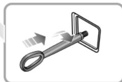
Su automóvil está equipado con un ojo de remolque en la parte delantera, que se utiliza para colocar el gancho de remolque que viene en el kit de herramientas. El kit de herramientas está en el espacio de la rueda de repuesto debajo de la alfombra del maletero.
