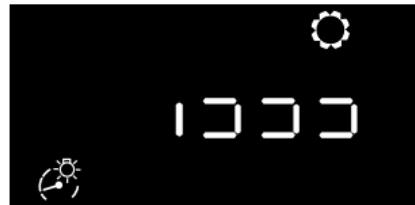
En esta interfaz, presione el botón OK en el interruptor a la derecha del volante o mantenga presionado el botón del computador de viaje en el indicador/interruptor de luces principales para ajustar el brillo de la luz de fondo. El nivel de brillo de la luz de fondo se puede ajustar presionando el botón arriba/abajo del interruptor a la derecha del volante o presionando brevemente el botón del computador de viaje en el indicador/interruptor de luces principales. Hay 3 niveles de brillo en total.
