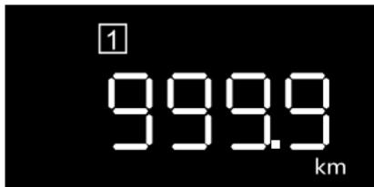
Muestra la distancia recorrida del viaje actual o desde el último reinicio. Este valor se restablecerá automáticamente 1 hora después de apagar el encendido y también se puede restablecer manteniendo presionado el botón OK en el interruptor a la derecha del volante o el botón del computador de viaje.
