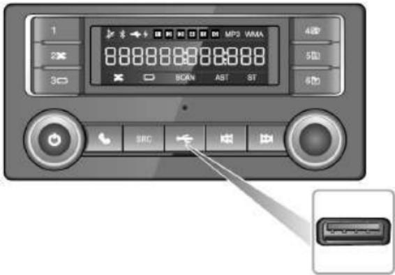
Conecte un USB e inserte una memoria USB en el conector USB.
