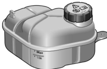
Se recomienda que el sistema de enfriamiento se revise semanalmente cuando el sistema esté frío y con el automóvil estacionado en una superficie nivelada. Si el nivel es inferior a la marca 'Min', abra la tapa del estanque de expansión del sistema de enfriamiento y rellene con el refrigerante, pero el nivel no debe ser más alto que la marca 'Max'.
