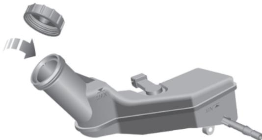
**Nota:** El líquido de frenos dañará las superficies pintadas. Si derrama accidentalmente el líquido de frenos sobre la superficie pintada, absorba inmediatamente cualquier derrame con un paño absorbente y lave el área con agua o champú para autos.
