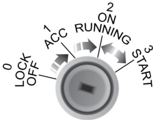
El interruptor de INICIO/PARADA está ubicado en el lado derecho de la columna de dirección. La función de cada posición es la siguiente:
