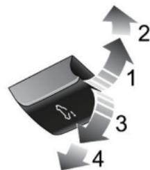
Empuje hacia arriba el interruptor del techo solar hasta la 1ª posición ( 1 ) y mantenga, el techo solar se abrirá manualmente de manera inclinada. El movimiento del techo solar se puede detener en cualquier momento soltando el interruptor.
