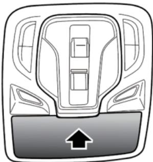
La caja de lentes está ubicada en la proximidad de las luces de cortesía delanteras. Presione el panel (como se indica con la flecha) y coloque los lentes en la caja de lentes después de abrirla. Cierre la caja de lentes cuando no esté en uso.
