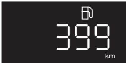
Esta función es automática y muestra la distancia que queda por viajar antes que el indicador de combustible indique vacío. La distancia cambiará cuando el vehículo sea recargado.
