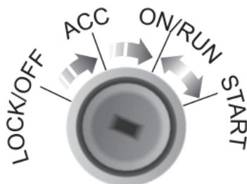
El interruptor de encendido se encuentra en el lado derecho de la columna de dirección. La función de cada posición es la siguiente:
