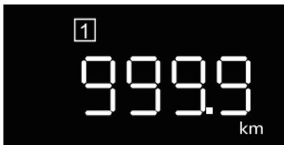
Muestra la distancia conducida del viaje actual o desde el último reinicio. Este valor se reiniciará automáticamente 1 hora después que se haya apagado el encendido y también se puede reiniciar presionando prolongadamente el botón OK que se encuentra a la derecha del volante o el botón del computador de viaje.
