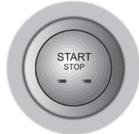
El interruptor de encendido para arrancar sin llave se encuentra en el panel de instrumentos a la derecha de la columna de dirección y pertenece al pulsador de arranque. Cada posición del botón START/STOP tiene la siguiente función:
