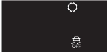
Cuando el motor se encuentra en marcha, presione brevemente el botón OK al costado derecho del interruptor del volante o presione prolongadamente el botón del computador de viaje en esta interface para activar o desactivar (On/Off) el sistema de control de estabilidad y el sistema de control de tracción. Cuando los sistemas se encuentran desactivados, se iluminará la luz de advertencia de apagado (Off) del sistema.
